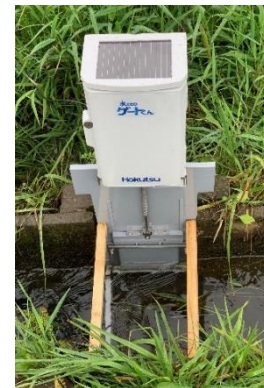
自動給水ゲート ※積水化学社
