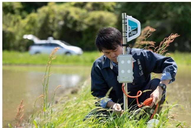
図 9-2：水田センサー設置方法
