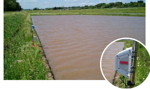
図 14-35 : 水田センサーU-8 設置状況
