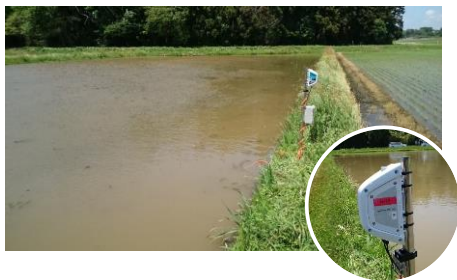
図 14-40 : 水田センサーU-13 設置状況
