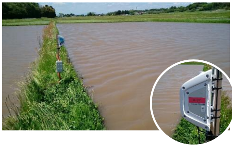
図 14-34 : 水田センサーU-7 設置状況
