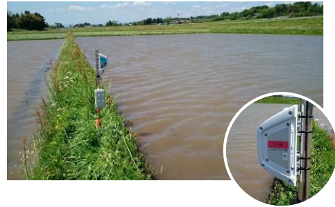
図 14-33 : 水田センサーU-6 設置状況
