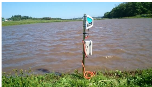
図 14-30：水田センサーU-3 設置状況
