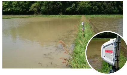
図 14-39 : 水田センサーU12 設置状況
