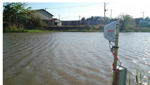
図 14-29：水田センサーU-2 設置状況
