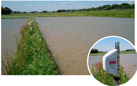
図 14-32 : 水田センサーU-5 設置状況
