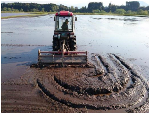
図 14-3：ハローによる代掻き
