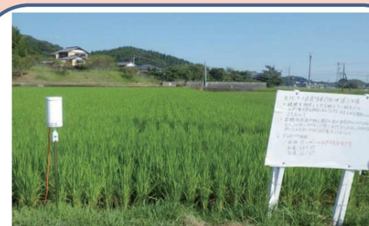
【写真1:水田センサーの設置状況】
