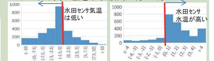
図4 水田センサと他の計測器との差の度数分布(新型)
