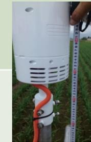
図. 新型水田センサーにある、センサー用の通気口
