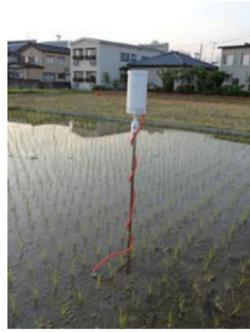
県作物研究センターのコシヒカリ生育調査ほ場に水田センサを設置し、気象データと水田センサとの整合、端末機の操作性等を検証した。併せて、現地ほ場にも設置することで、現地での実用性を検討した。
